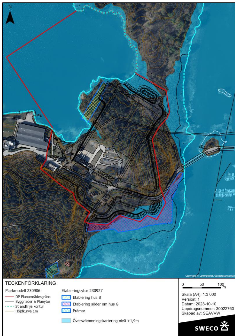
Figur 4. Översvämningskartering med vattennivå + 1,9 meter RH2000. Översvämningskartering @MSB, Bakgrundskarta @Lantmäteriet.
