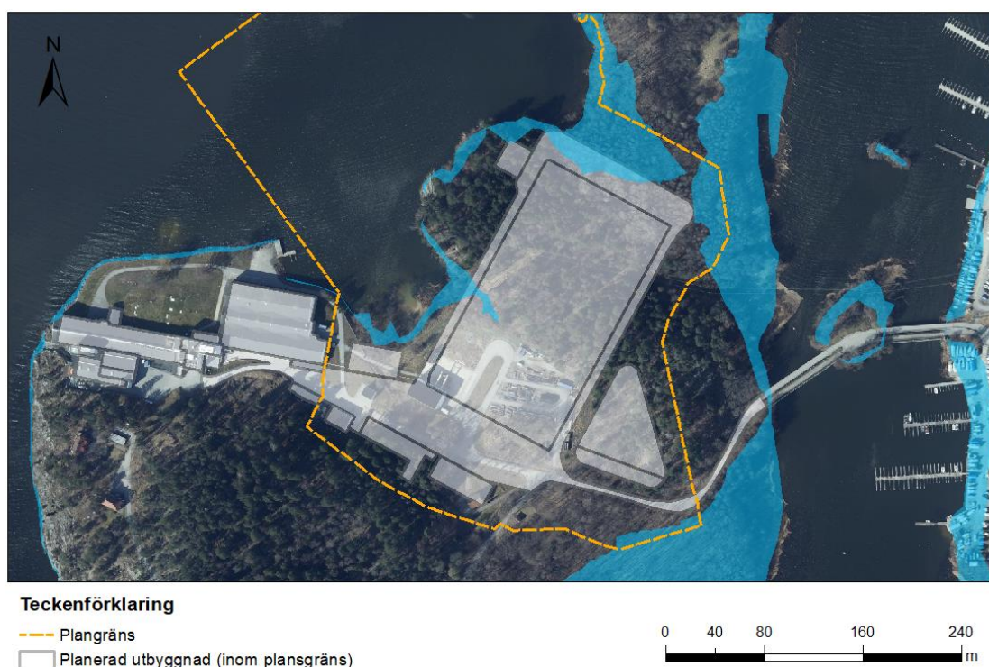
Figur 6. Översvämningskartering med vattennivå + 1,9 meter RH2000. Översvämningskartering @MSB, Bakgrundkarta @Lantmäteriet.
