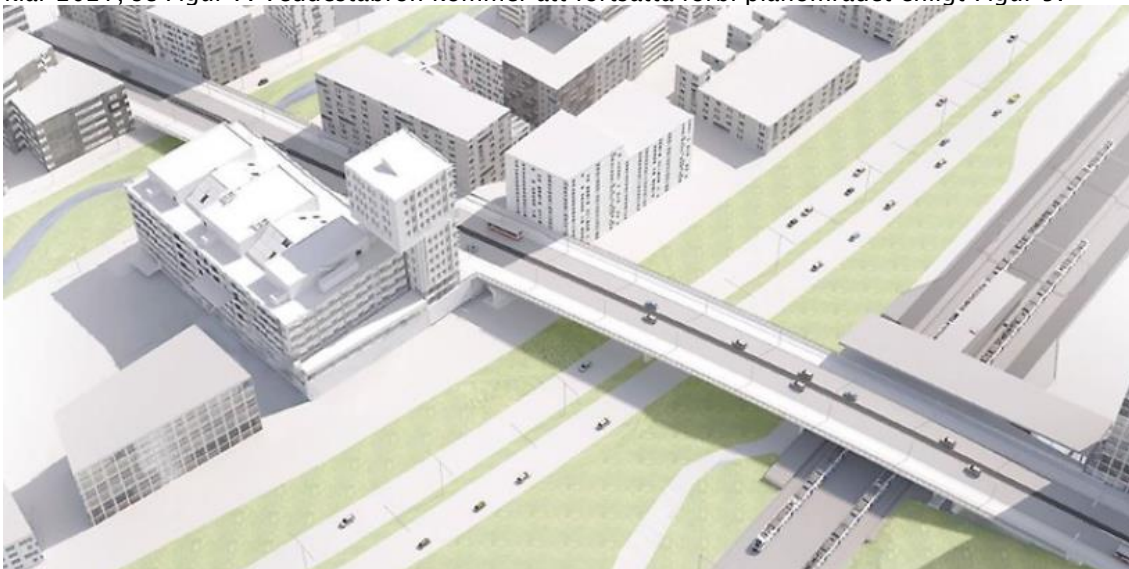
Figur 7 Visionsbild av Veddestabron. Bron blir 30 meter bred och får fyra körfält, ett för buss och ett för bil i vardera riktning, samt en gång- och cykelväg i vardera riktning. Till höger i bild syns entrén till den nya kollektivtrafikknutpunkten i Barkarby med tunnelbana, bussterminal och tågstation (Järfälla kommun, 2018)
