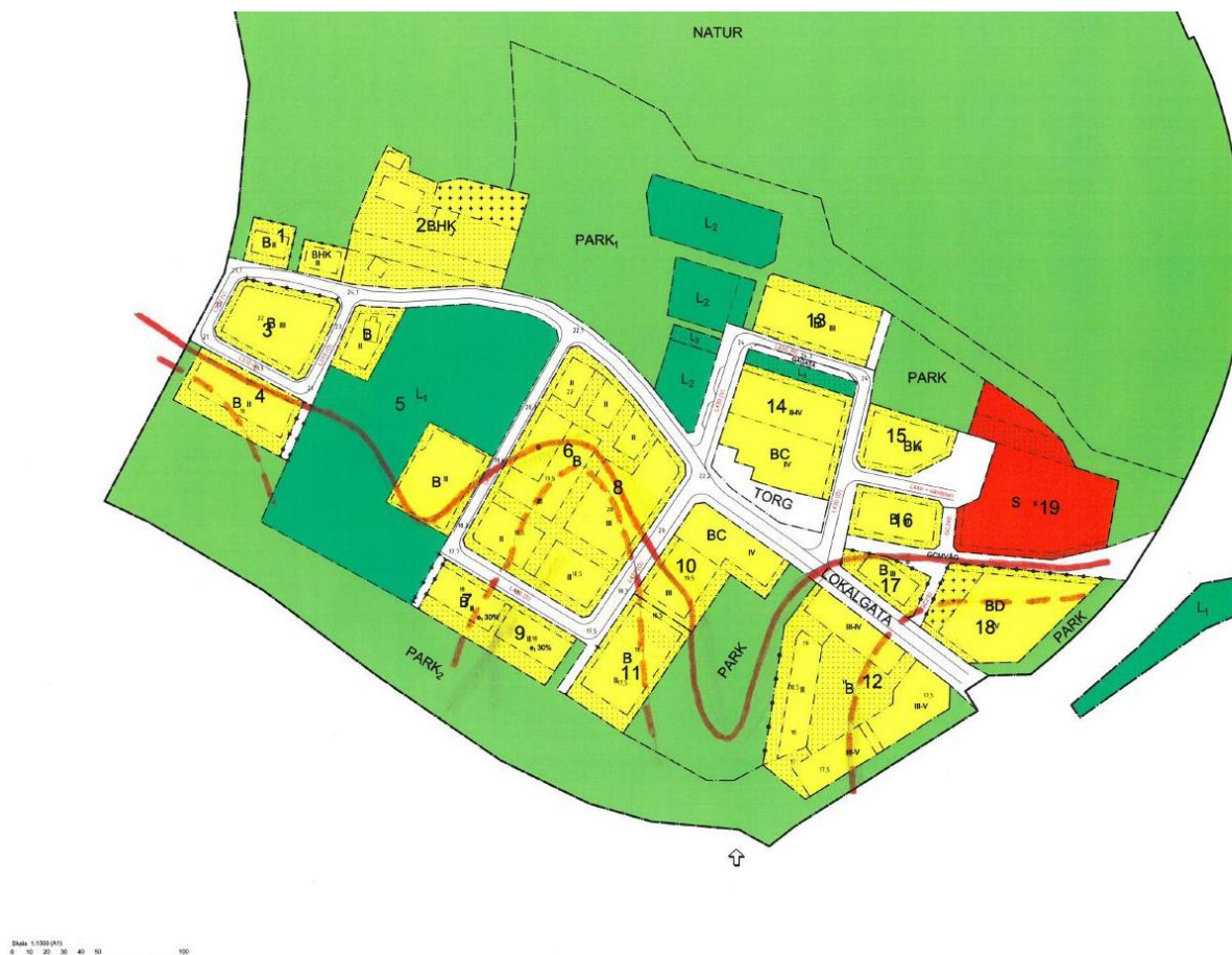
Figur 12. Ungefärlig avgränsningslinje, markerad med röd linje, där området söder om denna linje är känsligt utifrån sättnings- och stabilitetsproblem ned mot Veddestabäcken. Söder om de streckade röda linjerna är lermäktigheten vanligen mer än 2 m, och därmed sättningsproblemet störst.
