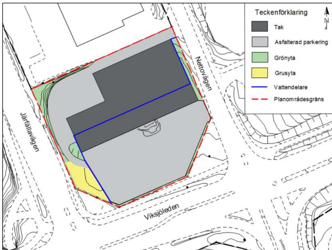
Figur 3-2. Beskrivning av detaljplaneområdets nuvarande markanvändning och delavrinningsområden. Planområdet är markerat med röd streckad linje.
