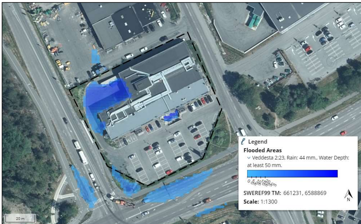
Figur 3-9. Översvämningsutbredning vid 44 mm regn (djup > 5 cm) från SCALGO Live. Ungefärlig planområdesgräns är markerad med svart streckad linje.
